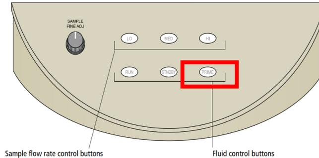
4. Laver le cytomètre : Placer sur le support un tube avec 3 ml de C (eau) et appuyer sur RUN/HI. Laisser 10' puis passer le cytomètre en mode STANDBY/LOW
